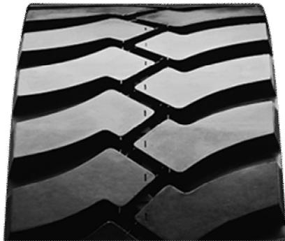
Banda de rodamiento para neumáticos radiales y diagonales en ejes de tracción.
